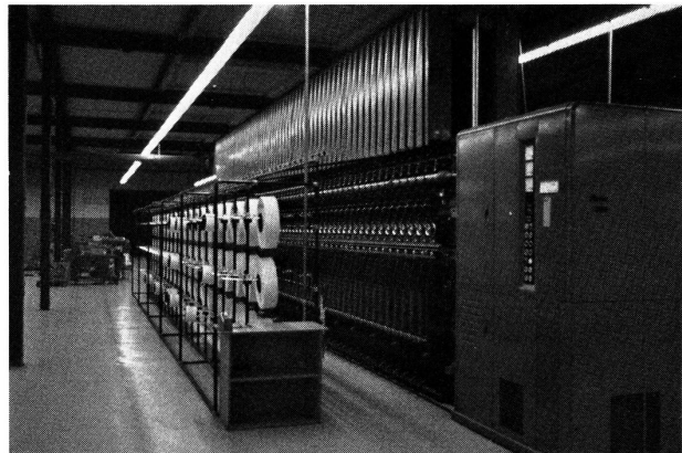
Texturiermaschine in Zusammenarbeit mit der Firma Rieter entwickelt und gebaut, läuft bis 1000 Meter je Minute.
