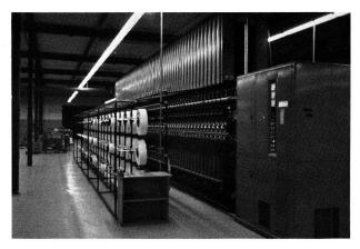
Texturiermaschine in Zusammenarbeit mit der Firma Rieter entwickelt und gebaut, läuft bis 1000 Meter je Minute.
