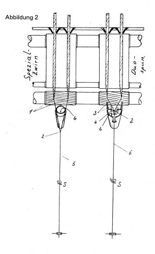
Abbildung 2 zeigt in einer Vergleichsskizze das DUO-SPUN-System gegenüber einem normalen Spezialzwirnverfahren. Es soll damit veranschaulicht werden, worin die Begründung der Vorteile für die Punkte 2, 3, 6 und 8 liegen.
