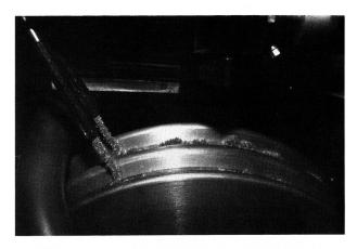
Bild 3 Ablage des Texturgarnes auf der Kühltrommel
