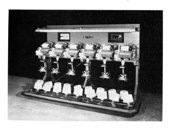
Die piezoelektronischen Fadenlaufwächter, kombiniert mit den Fadenbremsen, sind sehr reaktionsschnell und haben eine Ansprechzeit von 0,01 sec. Sie registrieren die Bewegungen der laufenden Fäden. Durch Berühren einer Sensortaste auf der Gehäuseoberseite kann der Fadenwächter ausgeschaltet werden. Beim Einziehen eines Fadens wird der Sensor wieder automatisch aktiviert.
