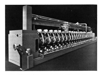
Mayer Coner in einseitiger Bauart mit 24 Spuleinheiten, Spulenwechsler und Abblaseinrichtungen (Karl Mayer GmbH)
