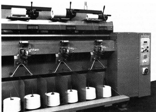
Präzisionswickel-Fachmaschine für 2faches Fachen
