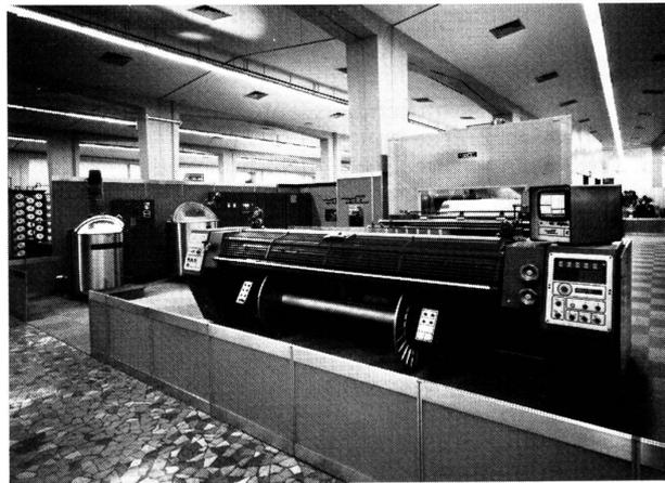
Abb. 10: Teilansicht der Schlichtanlage Typ PROCOMAT (Zell)
