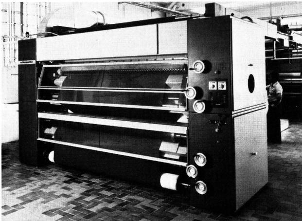
Die Pol-Schermaschine OPTIMA eignet sich insbesondere für die Bearbeitung von Decken, kurz- und langflorigen Web- und Raschelpflüschchen, sogenannten «High-Pille»-Artikeln, Frottévelours, Samt, Pelzimitationen, gerauhten Web- und Wirkstoffen mit limitierter Elastizität.
