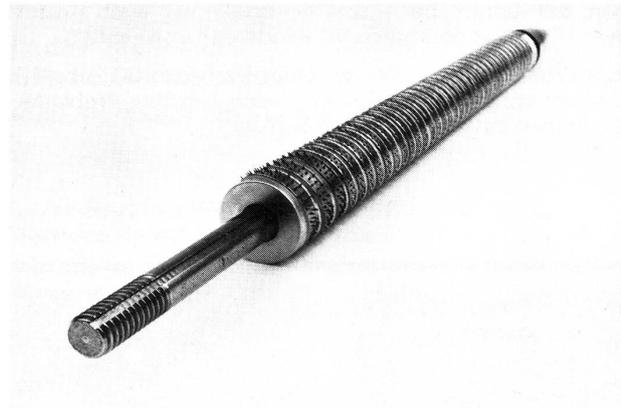
Dieses System ermöglicht dem Webermeister eine mühelose Wartung, da die Ellipsen «automatisch» in der richtigen Position aneinander gereiht werden.
