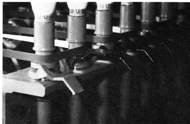
Im Rahmen modernster Forschungs- und Fabrikationsmethoden hat die Leder-Gruppe eine neue Spindelbandqualität, Typ SSB 83 entwickelt, welche den höchsten Ansprüchen im Spinnereisektor gerecht wird. Leder-Rapplon-Spindelbänder gewährleisten auch bei abgebremster Spindel und vollen Kops konstante Tourenzahlen der Spindeln.
