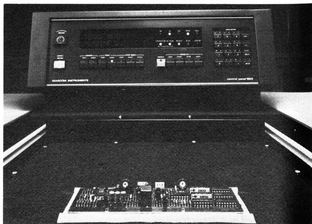
Anzeige und Bedienungseinheit des In circuit testers
