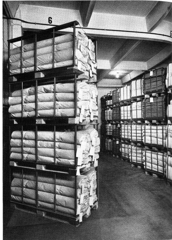
Längs- und Stirnaufstecklinge im Rohwarenlager eines Textilwerkes. Werkfoto: Drawag AG
