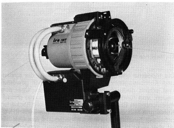
Die AB IRO bringt jetzt einen Schussfadenspeicher mit der Modellbezeichnung IWF-8107 heraus, der direkt an das normale Leitungsnetz der Weberei mit Spannungen von 200...600 V und drei Phasen angeschlossen werden kann. Transformatoren sind nicht mehr erforderlich. Die Liefergeschwindigkeit beträgt bei 50 Hz maximal 1100 m/min, bei 60 Hz bis zu 1250 m/min.
