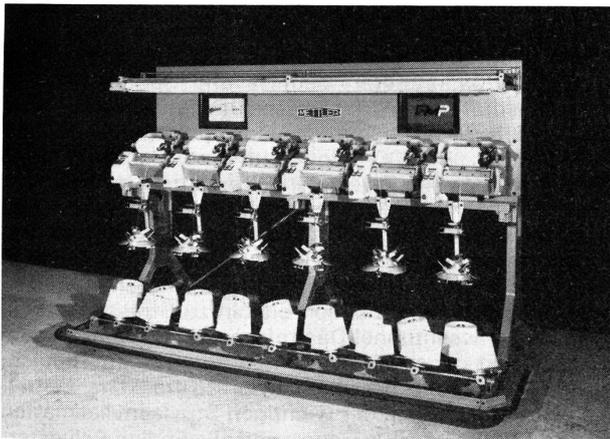
Die piezoelektronischen Fadenlaufwächter, kombiniert mit den Fadenbremsen, sind sehr reaktionsschnell und haben eine Ansprechzeit von 0,01 sec. Sie registrieren die Bewegungen der laufenden Fäden. Durch Berühren einer Sensortaste auf der Gehäuseoberseite kann der Fadenwächter ausgeschaltet werden. Beim Einziehen eines Fadens wird der Sensor wieder automatisch aktiviert.
