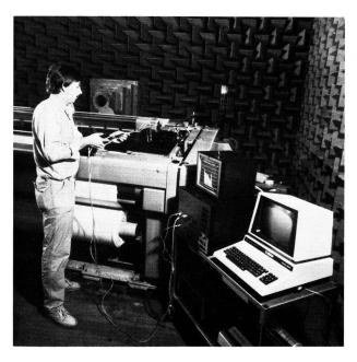
Akustische Intensitätsmessung an einer Sulzer-Webmaschine
