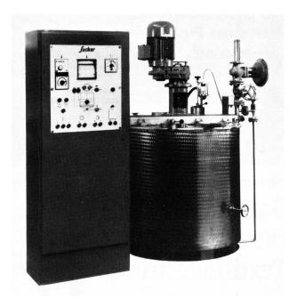
Der von der Firma **Gebrüder Sucker GmbH & Co.,** Mönchengladbach, neu entwickelte Rotor-Kocher ist eine Universal-Kochanlage mit automatischer Prozesskontrolle, geeignet zum Ansetzen und Kochen aller Schlichteprodukte. Der Kocher arbeitet drucklos und ist unter Berücksichtigung moderner Schlichten und hoher Konzentrationen konstruiert worden, wie sie z.B. bei Hochdruckguetschen zum Einsatz kommen.
