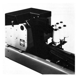
Webereien, die mit den allerneuesten Hochleistungs-Webmaschinen (Luft, Projekt, Greifer) arbeiten, eröffnet diese Weltneuheit: positiver Doppelkeilantrieb kombiniert mit der neuesten Elektronik und Mikroprozessorsteuerung neue Perspektiven.
