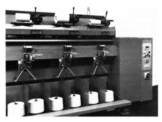
Präzisionswickel-Fachmaschine für 2faches Fachen Modell PSF-22
