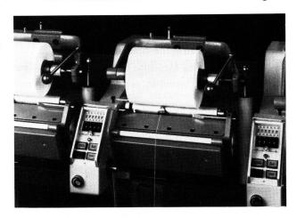
Für bestimmte Einsatzgebiete werden zur Vorlage an DD Maschinen mehr und mehr Fachspulen verlangt mit grösseren Garnlängen bei gleichen oder kleineren Spulendimensionen, um einerseits den Kraftbedarf zu reduzieren und andererseits längere knotenfreie Zwirne zu erhalten. Im weiteren soll der Ablauf der Fachspulen möglichst gleichmässig sein, und die Spule sollte keine Bildzonen aufweisen. All diese Forderungen erfüllt die Fachspule mit Präzisionswicklung.
