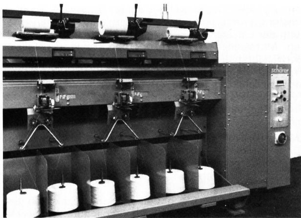
Präzisionswickel-Fachmaschine für 2faches Fachen Modell PSF-22
