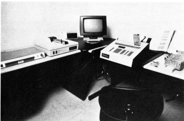
System 18 Stäubli-Programmierensystem für elektronisch gesteuerte Schafmaschinen
