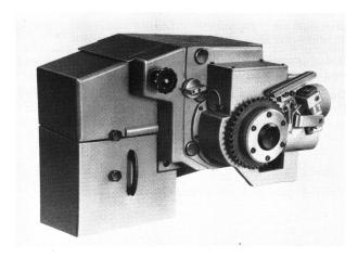
Rotations-Schaftmaschine Typenreihe 2000 mit integrierter Motorschuss-Suchvorrichtung
