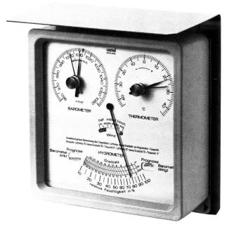
Figur 4 Kombiniertes Klima-Messgerät, enthaltend Baro-, Thermo- und Hygrometer. Diese Wetterstation eignet sich besonders für Messungen im Freien.
