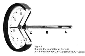
Das Messglied besteht aus einer Bimetallwendel. Bimetall ist ein Werkstoff, welcher aus zwei aufeinanderplattierten Legierungen mit unterschiedlichem thermischem Ausdehnungskoeffizient besteht und dadurch die Eigenschaft hat, sich bei Temperaturänderungen zu verformen. Im Falle einer Wendel entsteht eine Drehbewegung.
