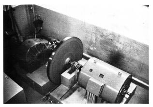
Rohrturbine, Getriebe, Schwungrad und Generator
