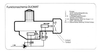
Folglich sind Luft- und Mischgeschwindigkeit bei Teillast kleiner, was zu Luftüberschuss führt. Daraus ergibt sich ein grösserer Energieverlust infolge schlechterer CO<sub>2</sub>-Werte und höherer Abgastemperaturen.
