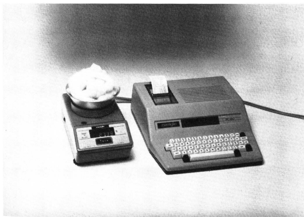
Die überschalige elektronische Waage PE 625 ermittelt hochgenau Kardenband-, Vorgarn- und Garngewichte. Über ein Kabel werden die Messwerte an den Tischcomputer PC 100 übertragen, der sie erfasst, verarbeitet und ausdruckt. In Sekundenschnelle errechnet er eine ausführliche Statistik mit CV-Wert. (Werksfoto Zweigle)
