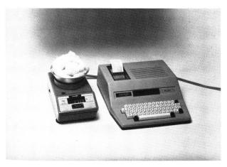
Die oberschalige elektronische Waage PE 625 ermittelt hochgenau Kardenband-, Vorgarn- und Garngewichte. Über ein Kabel werden die Messwerte an den Tischcomputer PC 100 übertragen, der sie erfasst, verarbeitet und ausdruckt. In Sekundenschnelle errechnet er eine ausführliche Statistik mit CV-Wert. (Werksfoto Zweigle)
