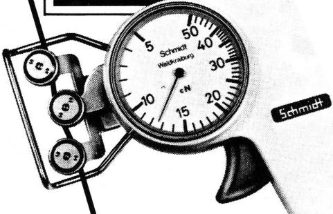
**Zugspannungsmesser Type Z**
