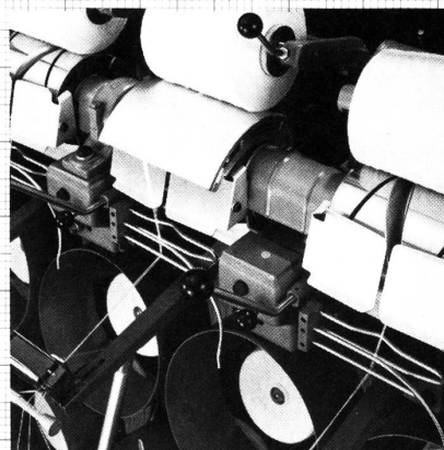
FMX mit wilder Wicklung und piezo-elektronischer oder elektro-mechanischer Fadenüberwachung
