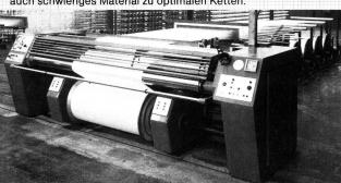
Die Assemblieranlagen mit neuen Zettelbaum-Bremstechniken und automatischer Kettbaumbewicklung erlauben Arbeitsgeschwindigkeiten bis 300 m/min.
