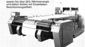
Die Zettel-Schlichtmaschine beschlichtet prozeßsicher mit 400 m/min Filamentgarne mit programmierten Daten.
