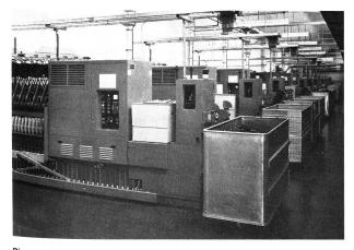
Ringspinnmaschinen CF 800/CF 900 mit Kops-Abzugsautomat LA 300
