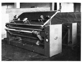
Maschine mit direkter Aufrollung, die vorne hydraulisch abgesenkt werden kann.
