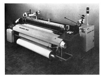
An der 2. ITMA 1955 wurden erstmals Luftdüsenwebmaschinen gezeigt. In der Zwischenzeit haben mehrere Webmaschinenhersteller die Entwicklung dieses Eintragssystems vorangetrieben.
