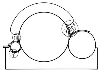
Für den Anbau von Pos. 4 ist Voraussetzung, dass eine leistungsfähige Kardenabsaugung vorhanden ist.
