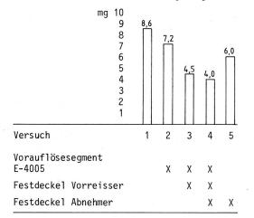
diesem Falle schwer zu erzielen. Es sind jedoch Tendenzen sichtbar, welche zeigen, dass der Versuch D 4 beim Einsatz aller drei C-Cleaner-Komponenten am besten ausgefallen ist. Obige Resultate stimmen mit der visuellen Beurteilung der Garne überein, d.h. die Prüfer haben das Garn aus D 4 an erste Stelle gesetzt.
