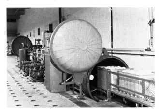
Vollautomatische Vakuum-Dämpfanlage Typ «Tunneldämpfer TW»
