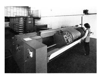
Robuste und äusserst leistungsfähige Maschine. Programmierter Taschenrechner zum einfachen Ermitteln der Maschineneinstellung. Kontrollprogramm zur Überprüfung der eingestellten Wickeldaten. Vorzügliche Kettqualität bei einfachster Bedienung. Bäume bis 800 mm Scheibendurchmesser. Schärgeschwindigkeit bis
