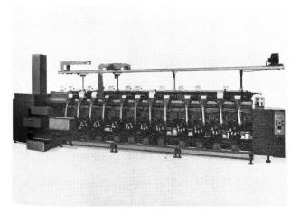
1 Präzisionswickel-Kreuzspulautomat Modell PSA-27 mit 20 Spulstellen, Abzug ab Kopsen oder Zettelresten, wahlweise mit Knoter oder Spleisser
