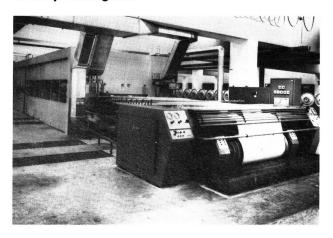
Die Anlage benötigt weniger als die Hälfte der bisher notwendigen Wärmeenergie und ermöglicht eine weitgehende Aufteilung der Kette zum Trocknen. In der Maschine sind folgende Neuentwicklungen enthalten:
