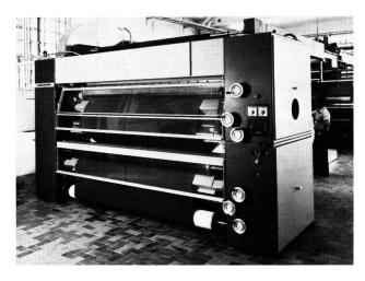
Die Pol-Schermaschine OPTIMA eignet sich insbesondere für die Bearbeitung von Decken, kurz- und langflorigen Web- und Raschelplüschen, sogenannten «High-Pille»-Artikeln, Frottévelours, Samt, Pelzimitationen, gerauhten Web- und Wirkstoffen mit limitierter Elastizität.
