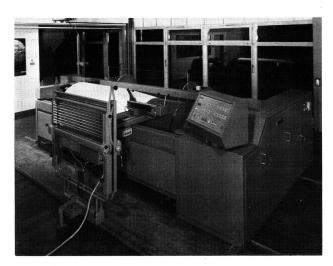
Abb. 11: Konusschärmaschine, Modell SF, mit elektronischer Auftragsregelung. Im Vordergrund der Prozessrechner
