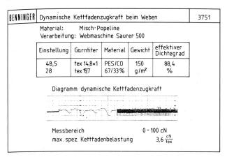
Abb. 2 Dynamische Kettfadenzugkraft beim Weben
