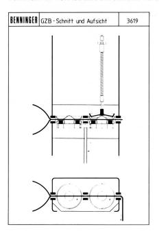
Abb. 6: Fadenspanner GZB mit positivem Tellerantrieb und zentral verstellbarer Tellerbelastung mittels Federdruckelement
