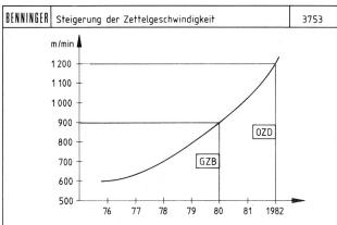
Abb. 7: Zunahme Zettelgeschwindigkeit in der Übersicht
