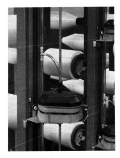
Abb. 8: Fadenspanner Aerotense 2 mit positivem Tellerantrieb, gestaffelter, pneumatischer Druckerteilung des Eingangs- und Ausgangstellerpaares und schrittweiser Fadenumlenkung vor und nach dem Spanner.
