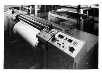
Abb. 9: Zettelmaschine, Typ OZD
