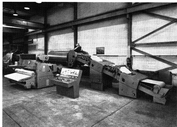
Bild 1 Nonwoven-Anlage, Type V 21/K 12: 2,6 m Arbeitsbreite
