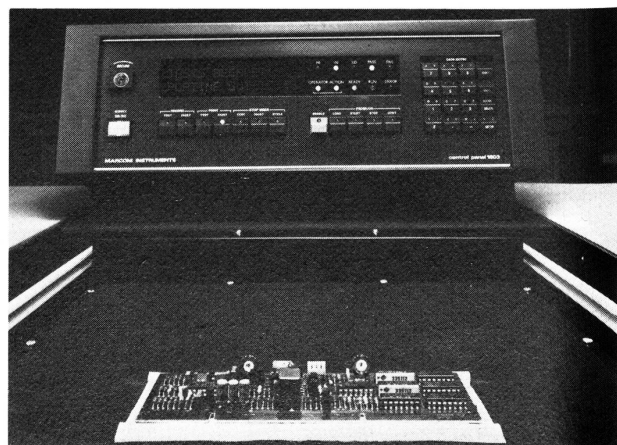
Anzeige und Bedienungseinheit des In circuit testers Werkfoto Siegfried Peyer AG, Wollerau
