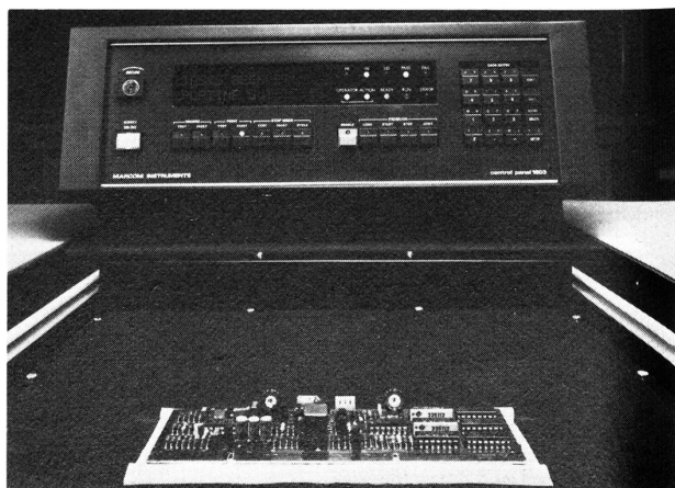
Anzeige und Bedienungseinheit des In circuit testers Werkfoto Siegfried Peyer AG, Wollerau
