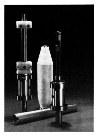
Umwindespindeln von SRO, Zürich, zum Herstellen von Kompakt- und Effektgarn. Foto: FAG Kugelfischer
