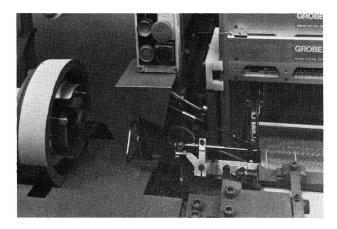
Fadendosiervorrichtung, gesteuerte Fadenblockierung und Hauptdüse
