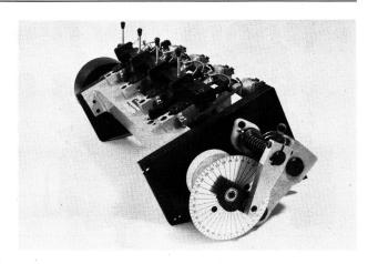
Durch eine Zusatzeinrichtung im Maschinengestell kann der Schussrapport bis 92 erhöht werden. Mit waagrechtem Zusatzkettenkasten beträgt der Rapport bis 350 Schüsse.
