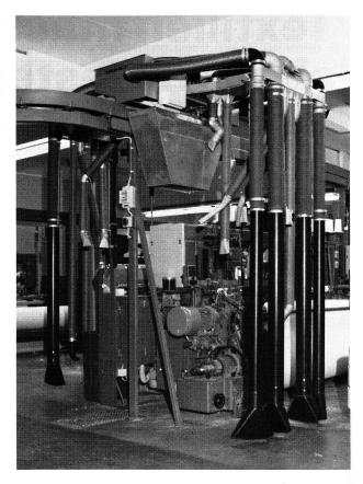
Für die Flyer steht das Aggregat SP 93 mit 2,8 kW zur Verfügung. Die Blasluft wird hier automatisch gesteuert, das heisst bei abgestellten Maschinen wird nur im Saugverfahren gearbeitet. Eingesetzt wird dieses Gerät über maximal 6 Flyern.
