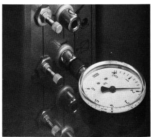
Messen der Luftdrücke mittels Handmanometer
