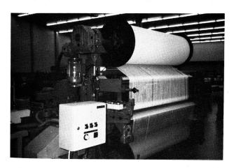
Die modernen, mit hoher Geschwindigkeit arbeitenden Webmaschinen stellen an die Kettablassvorrichtung hohe Anforderungen. Das neue System «Kast 83» kann für Grund- und Effektbaum eingesetzt werden. Ohne Rücksicht auf das Schusseintragsverfahren kann die Kettablassvorrichtung fast an alle Webmaschinen angebaut werden. Das Einsatzgebiet ist unbegrenzt und reicht von feinen bis dicht eingestellten Geweben.
