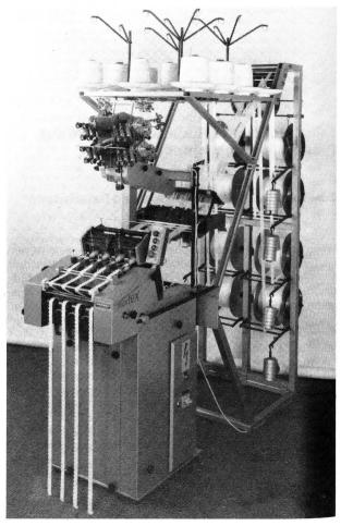
Besonderen Wert wird auf tadellose Qualität gelegt. Erstklassiges Material und einwandfreie Verarbeitung stehen an erster Stelle. Dazu kommen kompakte und solide Bauweise, moderne Konzeption und Linie, leichter Zugang zu allen Elementen, Zentralschmierung, hohe Webgeschwindigkeit und Präzisions-Lagersitze.
