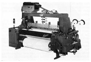
Günne-Luftdüsen-Webmaschine Air-Jet 2000
