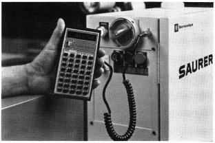
Pocket-Terminal zur Programmierung der Maschine
