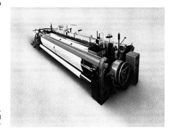
Sulzer-Einfarben-Projektilwebmaschine des Typs PU 153 ES E10 mit einer Arbeitsbreite von 3930 mm, ausgerüstet mit Exzentermaschine und mit einer Einrichtung zur Bildung von Dreherkanten. Die Maschine ist belegt mit einem Einschüttegewebe in L 1/1, zweibahnig à 179,4 cm, aus Baumwolle 15 tex (Nm 70/1, Ne 40/1) in Kette und Schuss, mit 41,1 Fd/cm in der Kette und 44 Fd/cm im Schuss.
