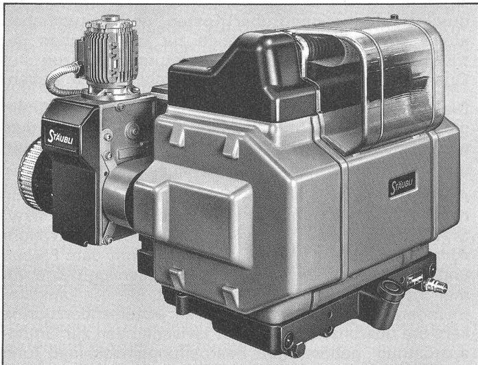
Die Schafmaschine Typ 2232 kann mit der neuen Schussuchvorrichtung Typ DA40 mit Einzelmotor-Antrieb und Druckknopf-Steuerung ausgerüstet werden.
