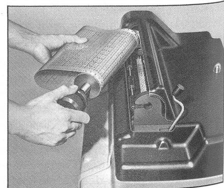
Die kompakte, für hohe Arbeitsgeschwindigkeiten ausgelegte Steuergruppe 5 zeichnet sich durch den kontinuierlichen Vorschub der Musterkarte und den schwenkbaren Kartenzyylinder aus.
