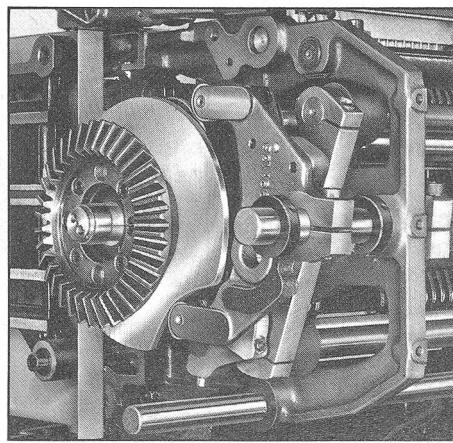
Komplementär-Kurvenscheiben auch für den Antrieb der Abstützmesser 3 mit neuartiger Doppelfunktion: für die zwangsläufige Steuerung der Zughaken 2 und für die spielfreie Verriegelung der nicht arbeitenden Zughaken.
