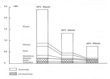
Abbildung 2 Aufteilung des kWh-Verbrauchs für Heiz- und Antriebsenergie bei der  $40\,^{\circ}$  C-,  $60\,^{\circ}$  C- und  $95\,^{\circ}$  C-Wäsche
