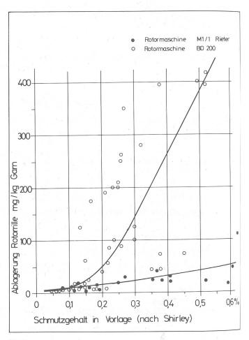
Bild 5: Einfluss des Schmutzgehaltes auf Rotormaschinentyp
