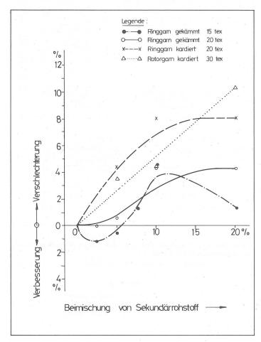
Bild 9: Einzelfadenfestigkeit, relative Veränderung durch Beimischung
