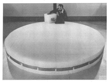
Sulzer Mellapak® für eine Absorptionskolonne zur Rückgewinnung von 800 kg/h Methylalkohol aus 50 000  $\rm m^3/h$  Abluft.
