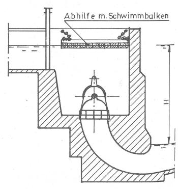
Fehlermöglichkeiten im Bereich der unmittelbaren Turbine
