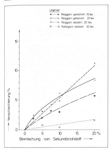
Bild 6: Garnungleichmässigkeit, relative Veränderung durch Beimischung
