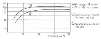
Bei Generatoren mit Gleitlagern werden die Lagerverluste auch von der Lageröltemperatur beeinflusst; genaue Messungen an einem 1250 KVA Generator mit 1000
