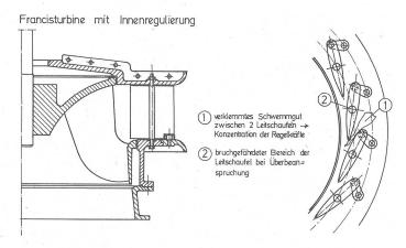
neuen Francis-Turbinen – halte ich überhaupt für problematisch, da die häufigeren Schliessvorgänge (z.B. Ausfall durch Netz KU) die Wahrscheinlichkeit eines Leitschaufelbruches (im Fachjargon «Schaufelsalat») erhöht. Deshalb werden moderne für vollautomatischen Betrieb konzipierte Turbinen mit nachgiebigen Leitschaufellenkern ausgerüstet.
