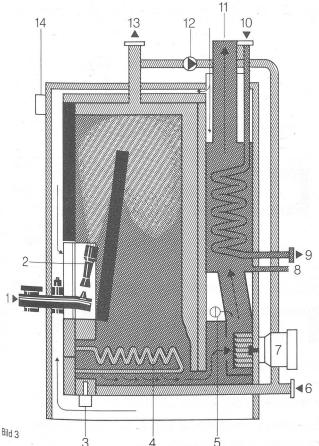
Pfinzipschema des Kondensationskessels im Hotel Les Chevreuils in Vers-chez- les-Blanc: 1 Gas; 2 atmosphärischer Gasbrenner; 3 Rücklauffühler; 4 Zwischen-Austauscher; 5 Saugzugventilator-Pressostat; 6 Kesseleintritt; 7 Saugzugventilator; 8 Abführung Kondensat; 9 Austritt Kondensaustauscher; 10 Eintritt Kondensaustauscher; 11 Rauchgase; 12 Umwälzpumpe; 13 Kesselaustritt; 14 Steuertableau.
