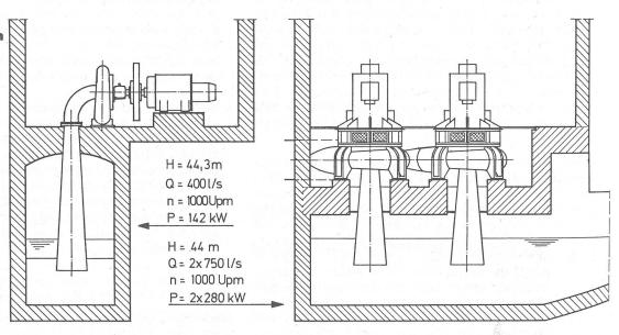
Ersatz von drei alten Francisturbinen durch zwei moderne Z-Rohrturbinen im KW Manegg Zürich
