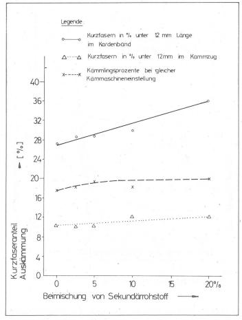
Bild 3: Auskämmung und Kurzfaseranteil
