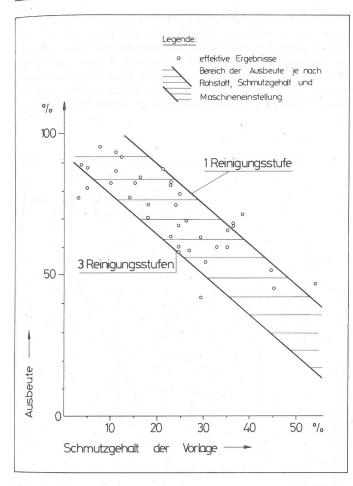
Bild 1: Ausbeute in Abhängigkeit des Schmutzgehaltes
