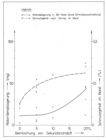
Bild 4: Schmutzgehalt und Rotorrillenablagerung
