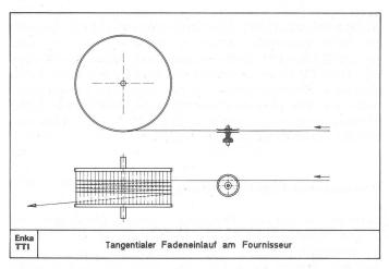
Abbildung 5: Tangentialer Fadeneinlauf am Fournisseur
