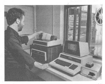
Der Computaweigh ist mit einem auf einem Mikroprozessor beruhen den Gewichtsmodul ausgerüstet, der aus einem Hochgeschwindig keits-Kassetten-Lesegerät, einem Bildschirmgerät mit Tastenfeld und einem Drucker besteht.
