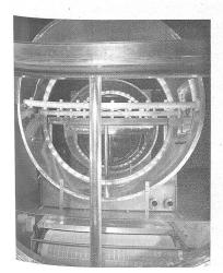
Serienmontage von vorfabrizierten Sulzer Hochleistungs-Luftwäschern mit automatischem Wasserfilter für Textilklimaanlagen.
