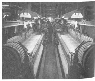
Der ganze Webmaschinenpark ist mehrschifflig ausgelegt.
