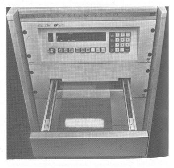
Peyer Texlab-System Faserlängen-Messgerät AL-100 für Baumwolle, Wolle und Chemiespinn-Fasern
