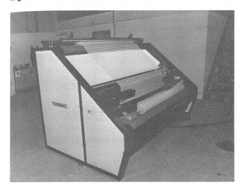
Die von der Texmac Ltd hergestellte Gewebeprüfmaschine der Baureihe 200 lässt sich für alle Gewebearten von feinem Maschenwerk bis hin zu schwerem Berufsanzugköper einsetzen.
