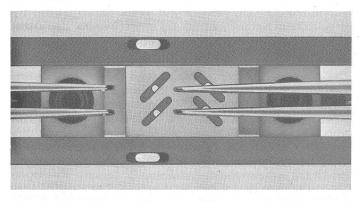
Die Gleitsteine, in welche die Schlitze eingelassen sind, werden von zwei U-Schienen geführt. In diesen befinden sich die Bohrungen für den Durchzug der Steherfäden, welche von hier aus zu den oben und unten liegenden Umlenkösen geführt werden. Von diesen Umlenkösen aus werden diese Fäden parallel zu den Stehernadeln zu deren Ösen geführt.
