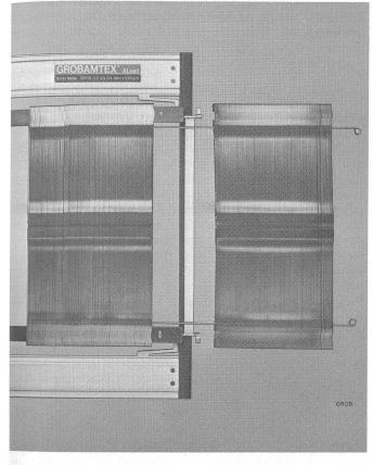
Auf dem Rüsttisch in der Einziehanlage BARBER COLMAN wird der Abstand der Litzentragschienen kontrolliert. Anschliessend werden die GROBAMTEX-Webelitzen auf den GROBAMTEX-Webeschaft aufgeschoben
