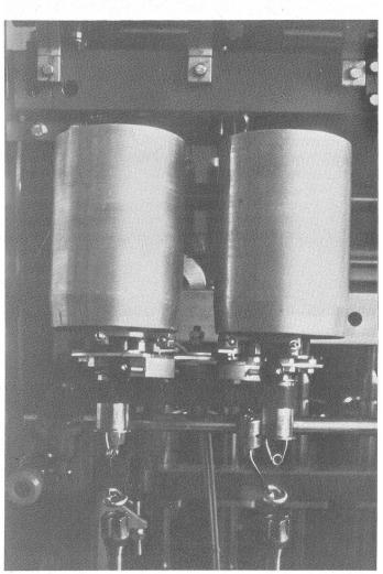
Aufnahme von einer Spindel mit Hohlspindel
