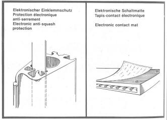
Das neue System besteht aus einer Metallfolie, welche durch Druck stromleitfähig wird.
