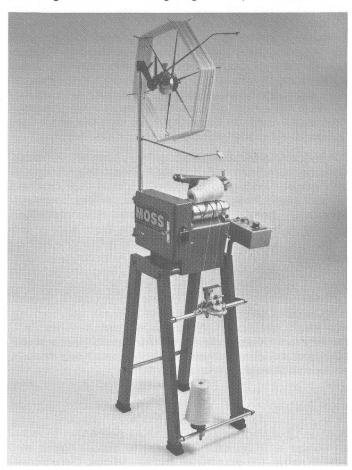
Die freistehende Ausführung der auch als integrierter Bestandteil der Grundausführung des «Backwinder» erhältlichen Strang-Kegel-Aufspulmaschine von Moss.
