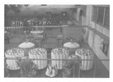
Ansicht der Färberei, im Vordergrund die 1600-Kilogramm-Doppelfärbeanlage
