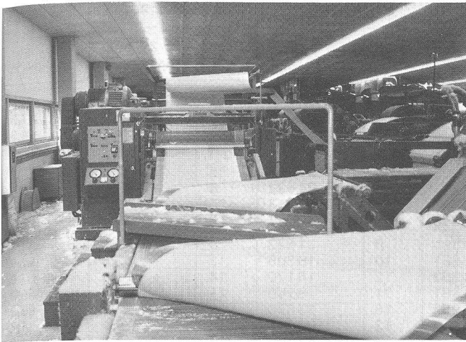
Der Faserflor wird zu einem Wattevlies zusammengefasst
