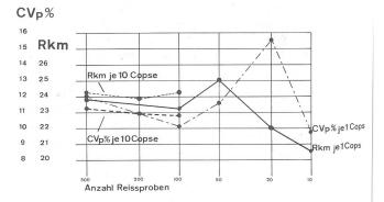
Abb. 2 Gegenüberstellung von Rkm (cN/tex) und der Streuung der Kraft CVp% bei verschiedenen Probegrössen innerhalb und zwischer Copsen.
