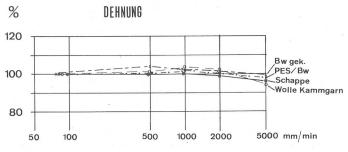
Abhängigkeit der Messergebnisse, oben Rkm (cN/tex), unten Dehnung E% von der Verformungsgeschwindigkeit. Die Ausgangswerte entsprechen ca. 20 Sek., sie wurden als 100% angenommen.
