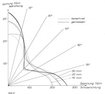
A00.3 Vergleich gemessener mit berechneter Spannung bei 20% Dehnung an einem Gewebe. Probenbreite 100mm.
