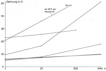
Abb.11: Kriechverhalten verschiedener Geotextilien bei 25 bezw. 60% der Reisskraft
