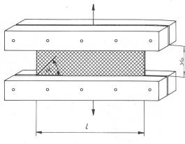
Abb 2: Streifenzugversuch mit grossem Verhältnis l/y<sub>o</sub>
