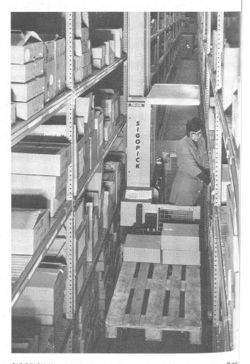
SIGOPICK-Kommissioniergerät im Einsatz im Textillager eines Gross verteilers. Die Bedienungsperson kommissioniert aus den Tablarregeren direkt auf die Palette. Letztere wird durch höhenverstellbaf Gabeln getragen. Die günstige Arbeitshöhe kann gewählt werden.
