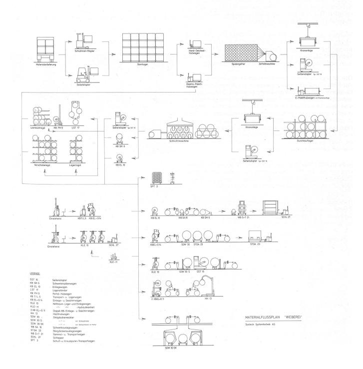
Alle Kettbaumtransportwagen werden immer häufiger mittels Zuggeräten bewegt, damit für den Transport zur Webmaschine eine Einmannbedienung erfolgen kann. Der Einlegevorgang selbst ist bei den heutigen Webmaschinenbreiten nur von 2 Mann rationell vorzunehmen. Dies vor allem bei eingezogenen Ketten, bei nicht eingezogenen und schmalen Ketten ist auch ein Zugmaschinentransport wenig sinnvoll und kann ein geübter Zettelaufleger problemlos alleine durchführen.
