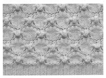
Abb. 9 Rechts/Links-Ware mit versetzter Einzelnoppenanordnung. Bei diesen zwei gleichen Mustern kommt stark der Teilungseffekt der ungleichen Maschinenfeinheiten zum Ausdruck
