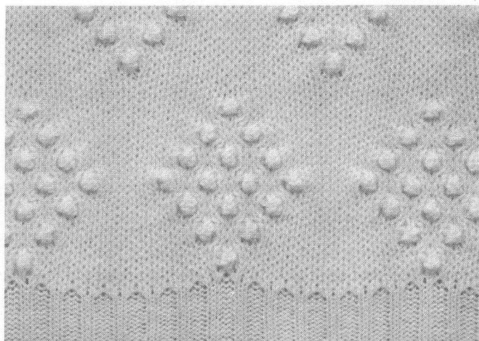
Abb. 6 Halbschlauch-Gestrick mit Noppen in jacquardmässiger, versetzter Anordnung
