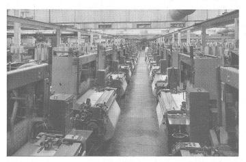
Anlage in USA mit über 400 Luftdüsenwebmaschinen RÜTI-te Strake L 5000
