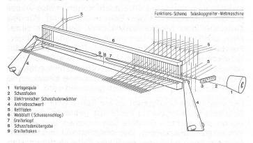
Beim Teleskop-Greifersystem bewegen sich die Schusseintragselemente frei und ohne Führungsorgane im Webfach. Diese Technik, die zum Beispiel gegenüber Stangengreifern eine enorme Platzeinsparung bringt, erweist sich auch als ideale Lösung bei der Herstellung von Frottierwaren, weil die Fachbewegungen und die Fachgeometrie der sehr schwach gespannten Polfäden in keiner Art und Weise gestört werden.
