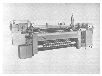
Greiferwebmaschine RÜTIF 2001, mehrfarbig mit Schaftmaschine
