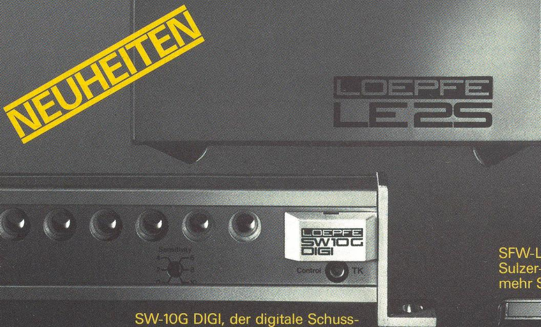
SW-10G DIGI, der digitale Schusswächter für Greiferwebmaschinen. Modernste Digital-Technik gewährleistet eine perfekte Überwachung von 1–8 Fäden, von Doppelschusseintrag und erfasst irrtümlich eingetragene Schüsse (Anti-2).
