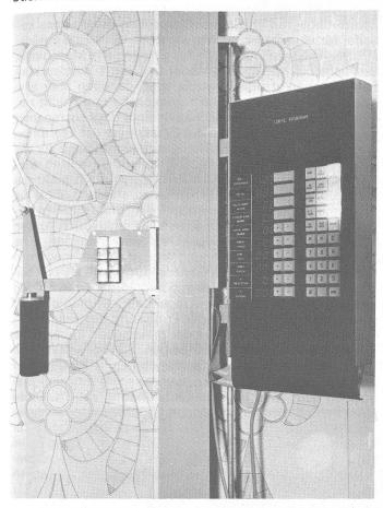
Auch im Bereich der Weberei-Ateliertechnik liefert Zangs weltweit elektronische Textilmusterdaten-Verarbeitungsanlagen, die Petrocard-Systeme 525. Durch Ausbau der Hard- und Software ist es inzwischen gelungen, mit diesem System von der reinen elektronischen Jacquardkarten-Herstellung zu einem universellen Musterungssystem für die Anwendungsbereiche Jacquardweberei, -strickerei und -wirkerei zu gelangen (Abb. 5).
