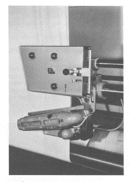
Mechanischer Kantenausstreifer LS 20 in Kombination mit Warenbahnführer KF 106
