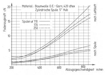
Bild 11: Verlauf der Fadenzugkraft nach der Spule und nach dem Leitblatt, in Abhängigkeit von Spulendurchmesser und Geschwindigkeit.
