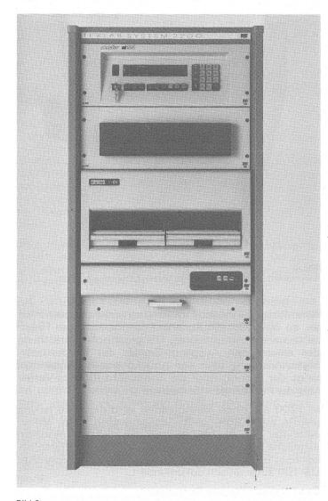
Bild 9: Texlab-System-Schrank mit AL-100, Diskettenlaufwerk und Minicomputer
