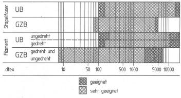
Bild 4: Einsatzbereiche der Fadenspanner GZB und UB
