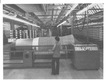
Bild 14: Konusschärmaschine, Modell SF-A, Bäumseite.
