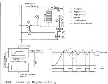
Wir unterscheiden unstetige Regeleinrichtungen bei denen das Stellglied nur wenige Werte annehmen kann (z.B. Zweipunkt-Regler). Bei dieser Regeleinrichtung schwankt die Regelgrösse mit einem Mittelwert über und unter den Sollwert. Diese Regeleinrichtungen eignen sich für sehr träge zu regelnde Aufgaben wie z.B. die Regelung einer Raumtemperatur.
