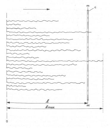
Bild 7: Durch den Kondensator analysiertes Fasermuster
