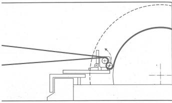
Bild 8: Regelduo, schematische Darstellung des Fadenlaufes.
