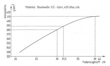
Bild 12: Wickeldichte in Abhängigkeit der Fadenzugkraft.
