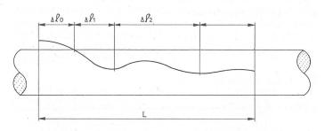
Bild 1: Beitrag der Einzelfaser zur Garnreissfestigkeit
