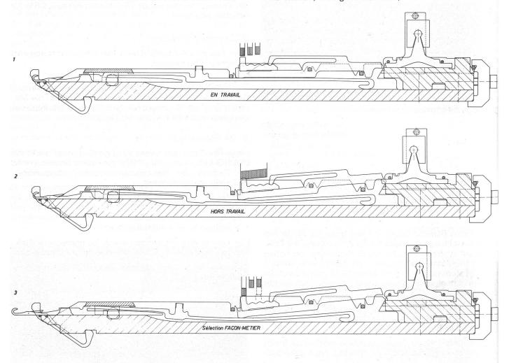
Im Weitern ist der Fuss der nicht arbeitenden Nadel im Nadelbett versenkt und eine geformte Masche wird also nicht in unnötiger Weise beansprucht.
