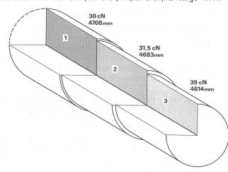
Bild 13: Vergleich Fadenzugkraft - Wickelumfang.
