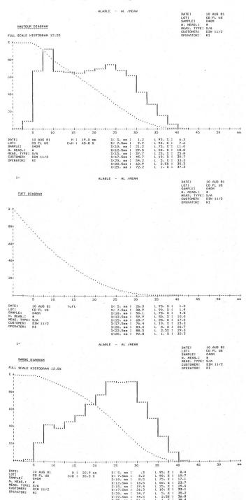
Bild 11: Vollständiges Messprotokoll aus der Messung einer USA-Baumwolle 11/8"
