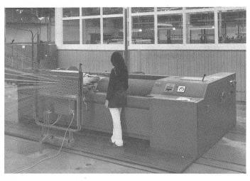
Bild 5: Konusschärmaschine, Modell SC-PERFECT, Schärseite.
