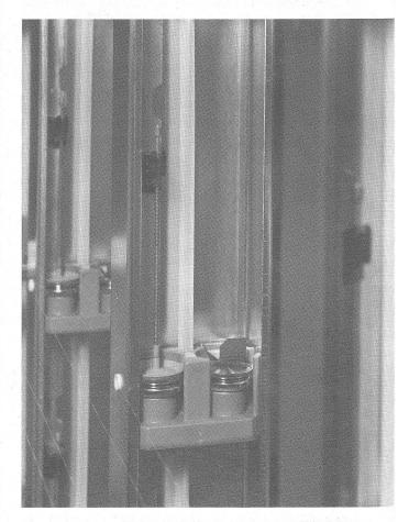
Bild 1: Normaldruckspanner, Modell GZB, mit zwei Tellerpaaren.
