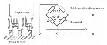
Das vom Stegabnehmer gelieferte Sinussignal wird im Eingang des Stegsignalverstärkers über eine Differenzverstärkerstufe verstärkt. Eine nachgeschaltete Triggerstufe erzeugt dann aus dem Sinussignal ein Rechtecksignal mit gleichem Tastverhältnis. Dieses Rechtecksignal wird in einer weiteren Differenzstufe in den Nadelimpuls umgeformt.
