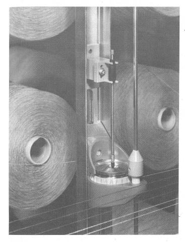
Bild 2: Normaldruckspanner, Modell UB, mit einem Tellerpaar.
