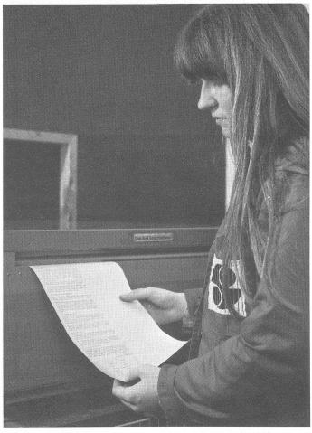
Die von der Lichtsatzmaschine belichteten Textspalten werden auf Fotopapier oder Film von der Entwicklungsmaschine ausgestossen.
