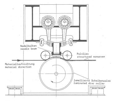
Abb. 3: DILO-Nadelmaschine Typ DI-LOFT I, mit einem Nadelbrett von oben nadelnd
