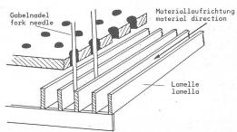
Das Prinzip des Strukturierungsverfahrens «DI-LOOP»
