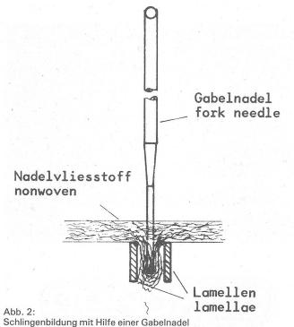
Abb. 2 zeigt schematisch den Fasertransport bei der Strukturierung, wobei zwischen zwei Lamellen auf der Ausstichseite Schlingen gebildet werden.
