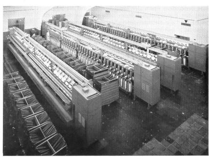
Abb. 4: Kreuzspulautomat AUTOCONER, Typ GKT mit Splicerautomatik zur Herstellung von 8''-Kreuzspulen für grobe Garne und die Teppichindustrie
