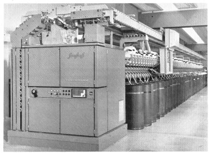
Abb. 5: Schlafhorst-Rotor-Spinspul-Automat AUTOCORO
