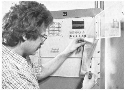
Abb. 6: Elektronisches Prozessdaten-Erfassungssystem INFORMATOR
