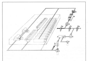
Schema der Luftführung in einer Baumwollspinnerei Es sind: 1 Faserkompaktor, 2 Vorfilter, 3 Trommelfilter, 4 Staubsammler (Jetfilter), 5 Abluftventilator, 6 Jalousieklappe Aussenluft, 7 Jalousieklappe Umluft, 8 Jalousieklappe Fortluft, 9 Zuluftventilator, 10 Düsenkammer, 11 Lufterhitzer
